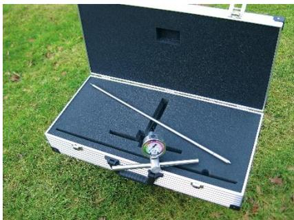
Die Lanze wird mit gleichmäßigem Druck auf den Griff in die Tragschicht eingeführt. Der Druck auf den hydraulischen Kolben wird auf das Manometer übertragen und das Ausmaß der Verdichtung wird auf der Skala in Bar ablesbar.
